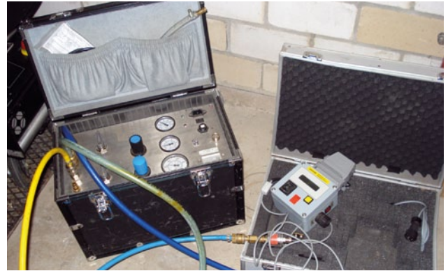
Druckprüfung für Abwasserkanäle
