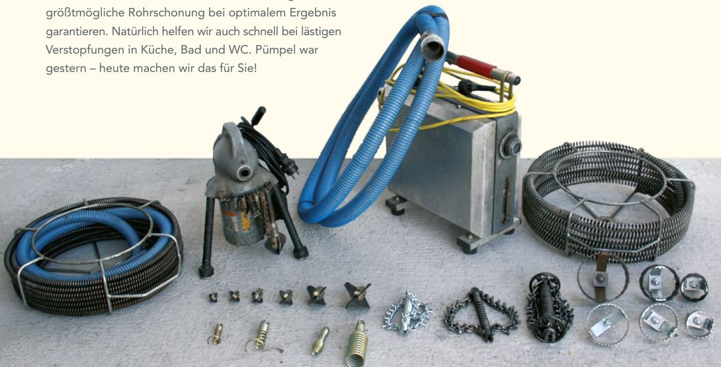
Verschiedene Bohr- und Kettenschleuderaufsätze und Werkzeug zur elektromechanischen Rohrreinigung
