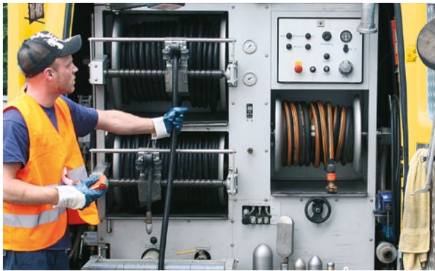
Einsatzfahrzeug bestückt mit Hochdruck-Spülaggregat
