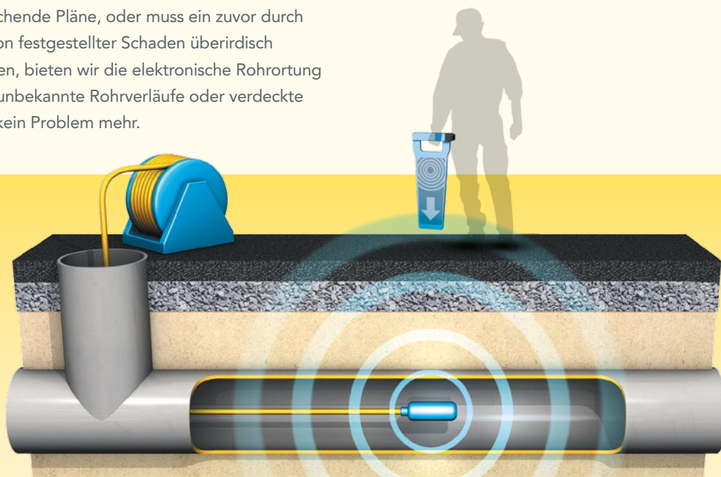
Elektronische Rohrortung mit einem Sender im Rohr.
